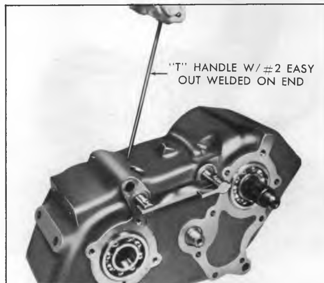
Fig. 6C—Removing Shift Fork Pins
