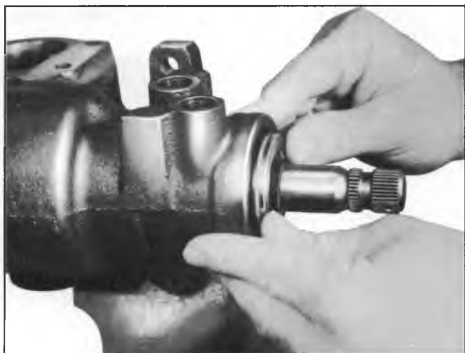
Fig. 56—Installing Valve Body
