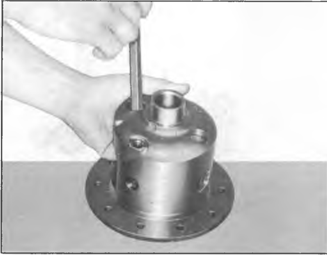
Fig. 9E--Removing Side Gear
