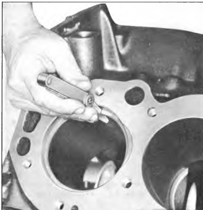
Fig. 56—Measuring Ring Gap
