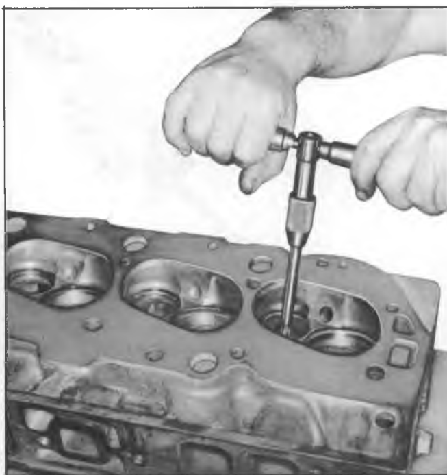
Fig. 22--Reaming Valve Guide
