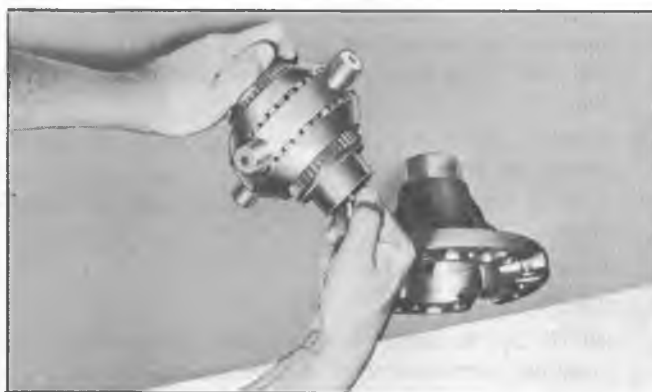
Fig. 6G--Assembling No-Spin Unit
